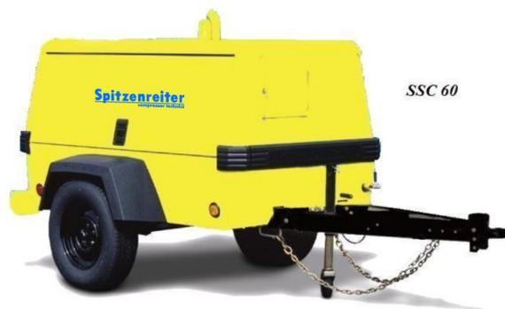
**Передвижной винтовой компрессор с дизельным приводом**
